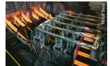
Blick auf eine Knüppelstranggießanlage
