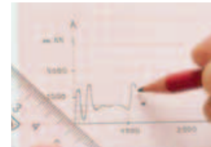
9 Verbinden der Höhenpunkte zu einer Profillinie
