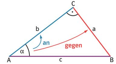
Im rechtwinkligen Dreieck lassen sich aus zwei Seiten oder aus einer Seite und einem spitzen Winkel die übrigen Seiten und Winkel berechnen.
