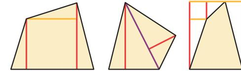
Körper berechnet man mithilfe von rechtwinkligen Stützdreiecken.
