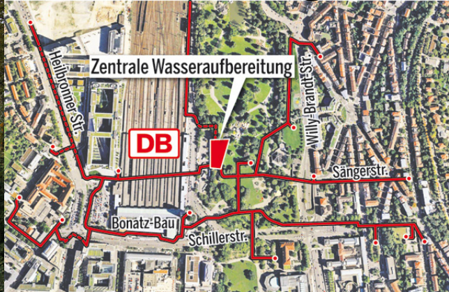
Leitungsnetz für das Grundwassermanagement an der Straße Am Schlossgarten
