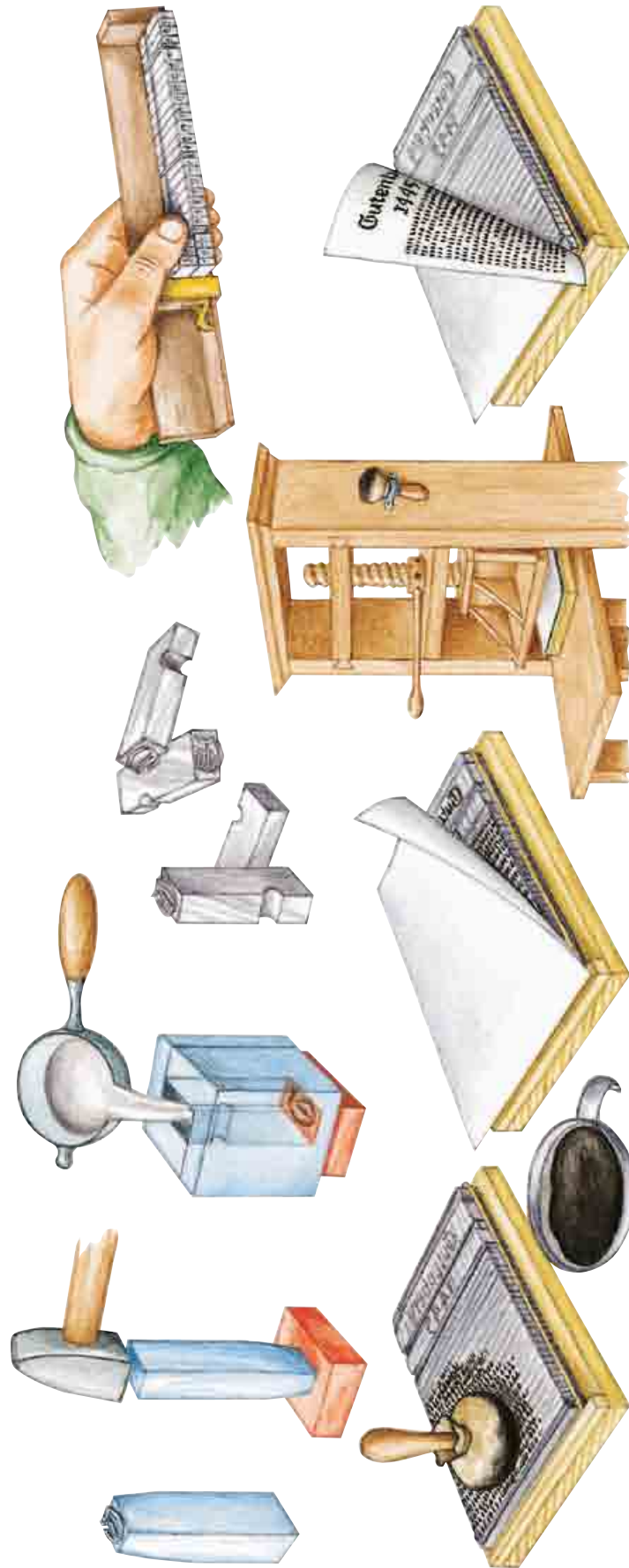
D1 Gutenbergs Druckverfahren Rekonstruktionsszeichnung
