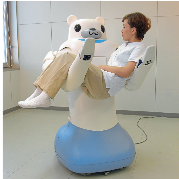
Der Pflegeroboter „ROBEAR“ ist der Nachfolger des „RIBA“. Er ist 90 kg leichter als sein Vorgänger und kann daher besser auf engem Raum manövrieren.
