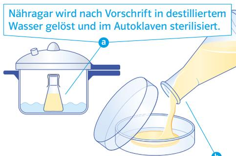
Nähragar wird nach Vorschrift in destilliertem Wasser gelöst und im Autoklaven sterilisiert.
