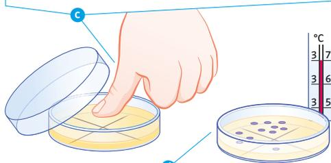
Die Petrischalen werden 2 Tage bei 37 °C bebrütet. Die Bakterienkolonien werden gezählt und Aussehen und Farbe notiert. Die Schalen dürfen nicht geöffnet werden!
