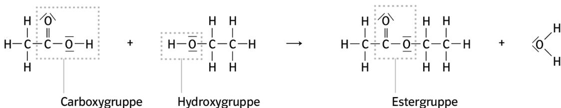
c) Bei der Reaktion handelt es sich um eine Kondensationsreaktion. Die Kondensationsreaktion einer Carbonsäure mit einem Alkohol bezeichnet man auch als Veresterung.
