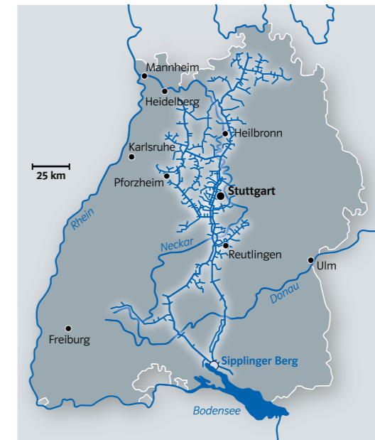
4 Das Leitungssystem der Bodensee-Wasserversorgung
