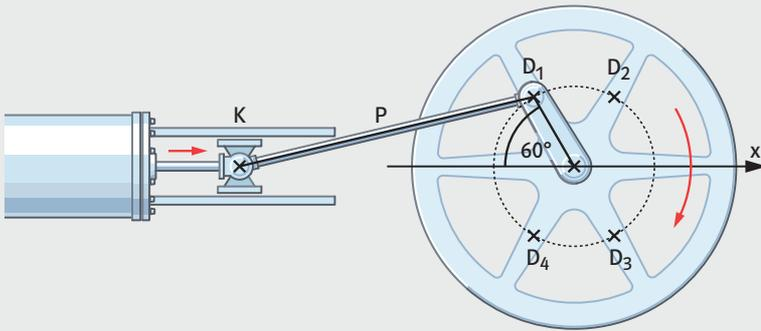
Die Kolbenbewegung der Dampfmaschine wird über den Kreuzkopf K, die Pleuelstange P und den Drehzapfen D in die Drehbewegung des Schwungrads umgesetzt. Die Lage von D ist durch den Drehwinkel bestimmt, den die Kurbel mit der positiven x-Achse einschließt.
