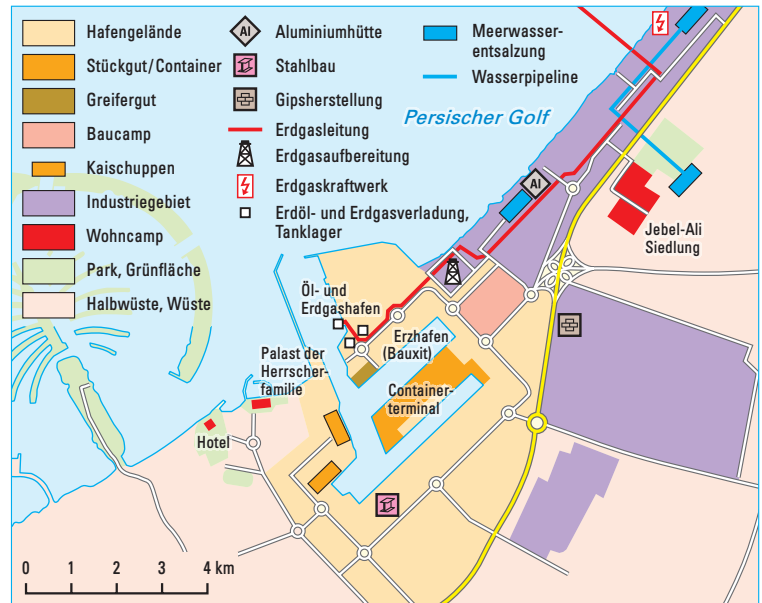
Industrie- und Hafenanlagen in Mina Jebel Ali
