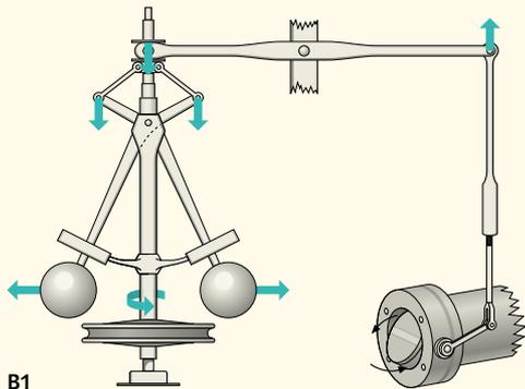
Ein außenstehender Beobachter sieht, dass die beiden Metallkugeln an dem Gestänge eine Kreisbewegung vollführen; um zu verstehen, woher die dafür nötige Zentripetalkraft  $F_Z$  stammt, muss man eine Kräftezerlegung der Gewichtskraft vornehmen (→ B5).
