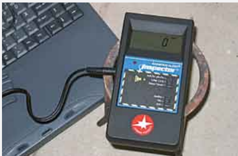
B1 Langzeitmessung mit automatischer Messwert- erfassung
