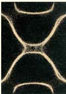
B1 Chladni'sche Figuren für zwei verschiedene Frequenzen
