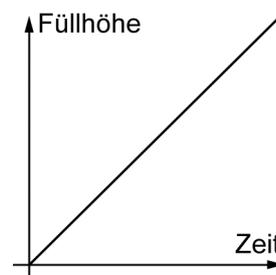
2 Das Schaubild zeigt das Füllen eines geraden zylinderförmigen Tanks.
