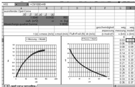
Die ermittelte effektive Stirnfläche ist  $1 \text{ m}^2$ , das ist die Hälfte der tatsächlichen Stirnfläche, der  $c_w$ -Wert beträgt also 0,5 und liegt damit etwas oberhalb des angegebenen Reklamewertes. Der Rollwiderstandsbeiwert ist mit 1% sehr hoch. Das liegt daran, dass es sich um einen Automatik-Corsa handelte, bei dem die Schaltung während des Ausrollversuches nicht auf Leerlauf umgelegt wurde.
