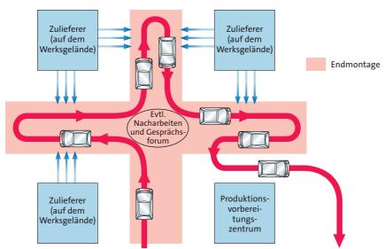
Das Produktionskonzept von MCC (Micro Compact Cars smart GmbH) sieht nach Karosseriebau und Lackierung acht weitere Stationen vor, die der Kleinwagen durchlaufen muss. Nach nur 4,5 Stunden ist er fertig und kann ausgeliefert werden. Die Fertigungstiefe im Smart-Werk liegt unter 10 %. MCC besorgt lediglich die Endmontage. Mehr als 90 % der Bauteile werden Just-in-Time montagesynchron angeliefert.
